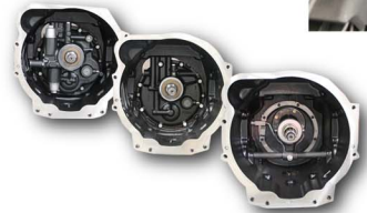
Tres opciones de transmisión: 8x8 con inversor mecánico, 8x8 con inversor hidráulico y 16x8 con inversor hidráulico Adicionalmente el Creep
